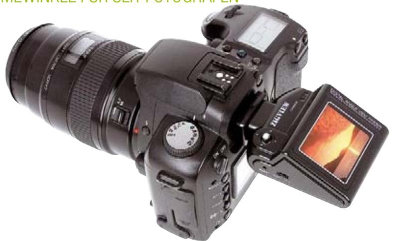
Von Kaiser kommt ein digitaler Sucher für SLR-Fotografen, die häufig aus ungewöhnlichen Positionen – zum Beispiel über Kopf oder dicht am Boden – fotografieren. Ziggview verfügt über eine kleine Videokamera, die am optischen Sucher der Kamera angekoppelt wird, und über einen Monitor, der das Sucherbild live zeigt. Der Anschluss an SLR-Kameras von Nikon, Fujifilm, Canon, Olympus, Pentax und Konica-Minolta erfolgt über Adapter. Das Spiel mit den Perspektiven kostet etwa 200 Euro.
