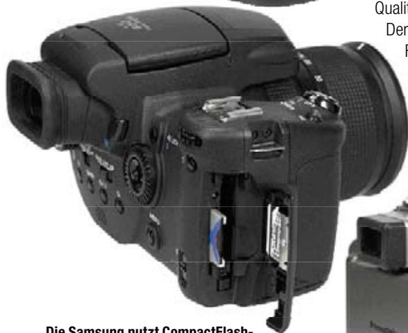
**Die Samsung nutzt CompactFlash-Karten vom Typ I und II. Sie kann daher zusätzlich Microdrive-Minifestplatten verwenden, die auch in der Sony R1 eingesetzt werden können. Die Sony bietet darüber hinaus noch einen Slot für alle Varianten des eigenen MemoryStick-Systems. Die Panasonic arbeitet nur mit SD-Speicherkarten.**
