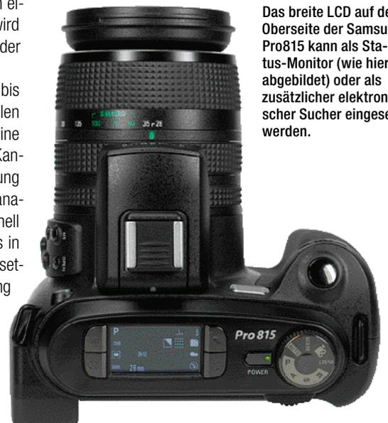
Das breite LCD auf der Oberseite der Samsung Pro815 kann als Status-Monitor (wie hier abgebildet) oder als zusätzlicher elektronischer Sucher eingesetzt werden.
