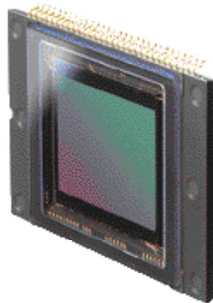
Der Bildsensor: Im Gegensatz zu anderen Cybershot-Kameras nutzt die R1 einen rauschärmeren CMOS.
