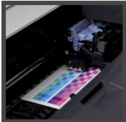
Nach dem Ausdruck eines Testblattes werden die insgesamt 729 Farbfelder in weniger als 10 Minuten ausgemessen und für die Kalibrierung genutzt
